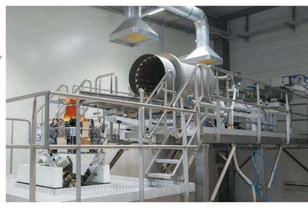
Vollautomatische Anlage: Die Mehrkopfwaage hat ein separates Gestell, um eine Übertragung von Schwingungen zu verhindern.
